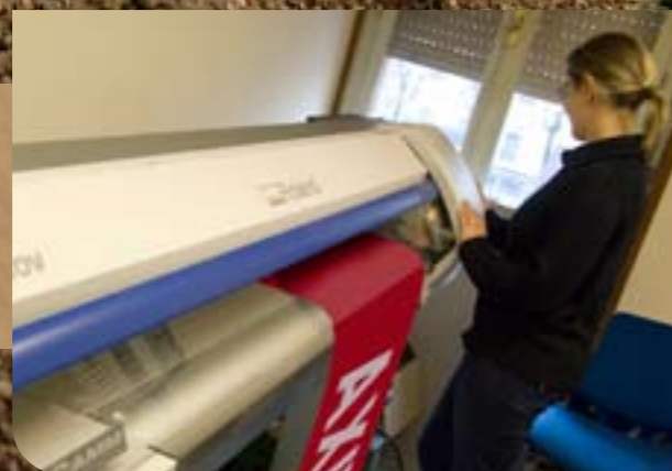
Plotter a ecosolvente 4 colori CMYK. Luce 137. 1080 dpi di stampa. Automazioni per la sequenza dei numeri.
